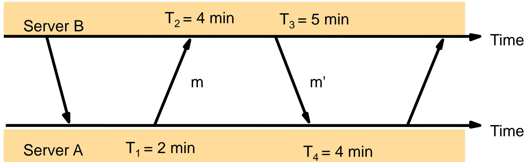
$$O = ((T_2 - T_1) + (T_3 - T_4)) / 2$$
