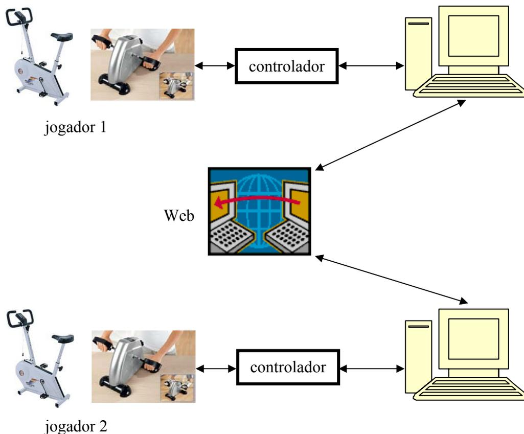
O bloco controlador terá como funções dar indicação ao PC da velocidade com que cada jogador pedala bem como da orientação que este dá (a partir do volante da bicicleta), podendo ainda controlar a resistência ao pedalar de modo a simular as dificuldades do terreno, como seja o caso de uma subida acentuada.
