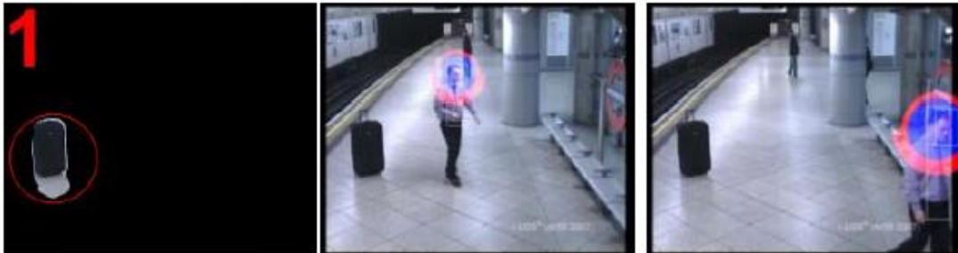
Figura 2 - Detecção de bagagem estática; O seguimento do proprietário é iniciado; Quando o proprietário sai de cena, o alarme é disparado. (Adaptada de [3]).
