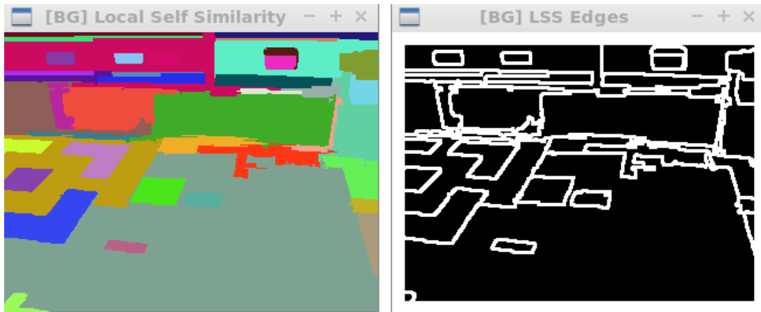
Figura 18 - Resultado da aplicação do descritor de similaridade local sobre o plano de fundo, e máscara com as arestas dessas zonas.
