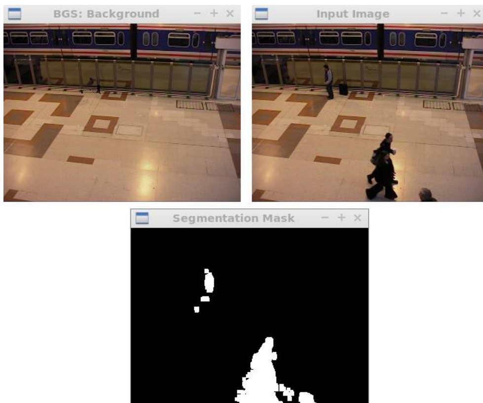
Figura 17 - Modelo do plano de fundo estimado, imagem de entrada e respetiva máscara de segmentação.
