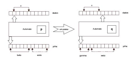
Figura: Transição  $((p,u,\beta),(q,\gamma))\in \Delta$  graficamente
