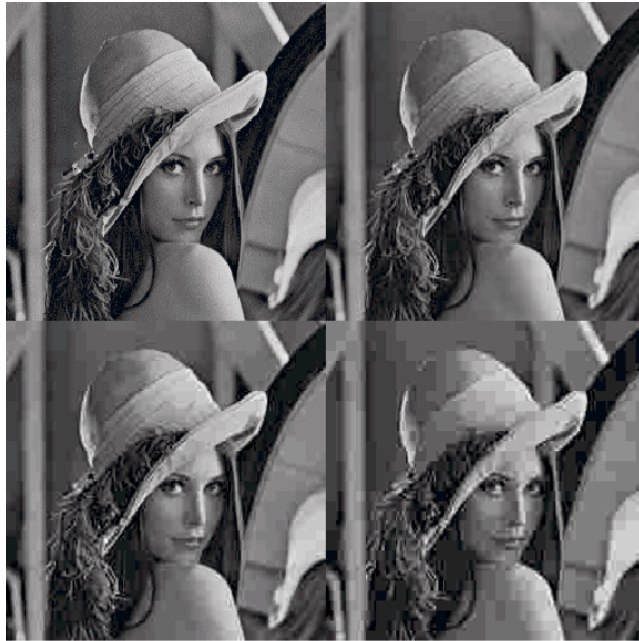
Figura 7.20: Imagem Lena comprimida a diferentes débitos. Cima, esquerda: 65536 Bytes (8 bpp); Cima, direita: 4839 Bytes (0.59 bpp); Baixo, esquerda: 3037 Bytes (0.37 bpp); Baixo, direita: 1818 Bytes (0.22 bpp).
